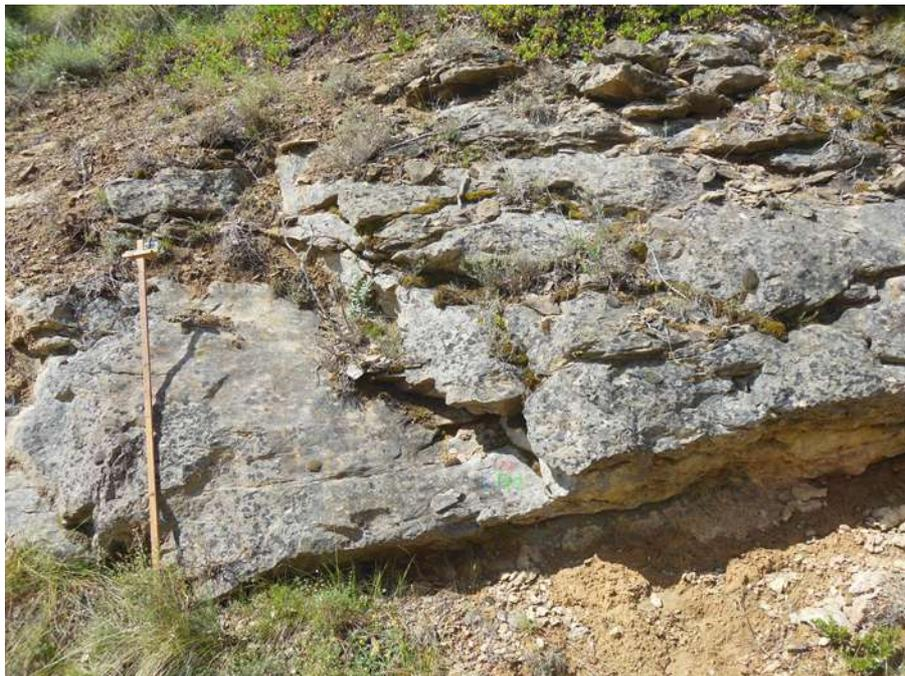
Figura 3. La vara de Jacob es un instrumento de longitud conocida que permite proyectar una visual que corresponde a la altura de la misma (1,5 m) y así calcular el espesor de un conjunto de estratos.
