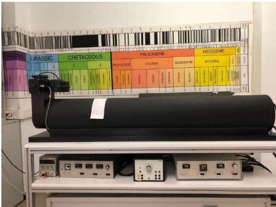
Figura 7. Horno para calentar y enfriar muestras en campo magnético casi nulo.
