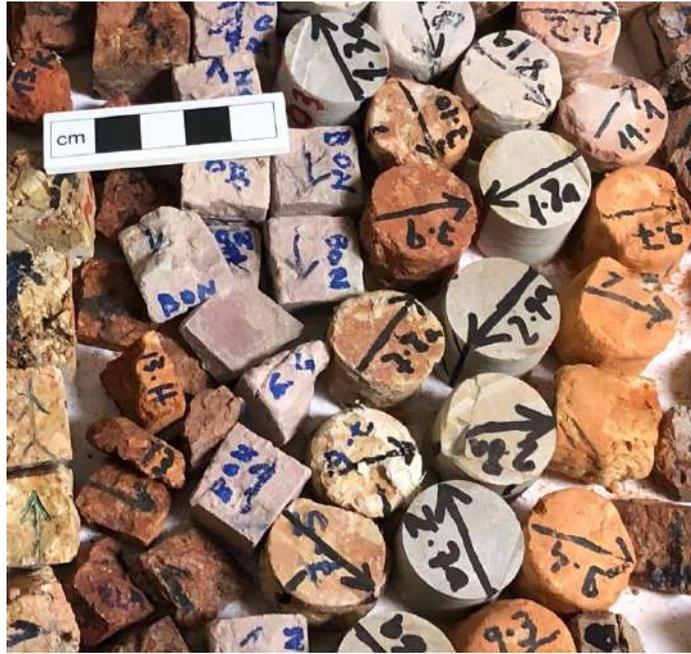
Figura 6. Ejemplos de muestras orientadas preparadas para su análisis.
